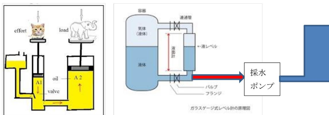
油圧器で「猫の力で象を持ち上げられる原理」が示されるように、パスカルの原理では連通する管の作用面積に比例して力が働く。力は押す力、引く力、いずれにも適用できる。この原理の前提として、力が働かないとき、連通管の液面の高さは水平で、力が働いたときに液面がずれて、停止した時、新たに液体が流入して水平に戻るには、適度の粘度がある油が用いられる。当然水でも機能するが粘度が小さいことと、水質が様々なに変化するため実用に適さない。
