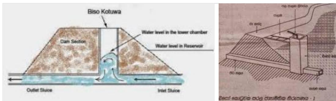
上図、bisokotuwa は、堤防本体に組み込まれたものから、貯水池本体に設ける取水塔に進化
