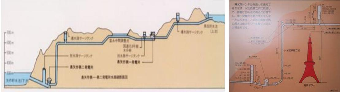
この図でみるとサージingtankは巨大なマンホールにすぎませんが、発電機＝揚水ポンプ手段に対してこの前後に設けられたこと、連通管構成であることが分かりやすい。かくも巨大な施設が地下で安全に稼働しているのは 21 世紀初頭の歴史的成果だと感嘆します。
